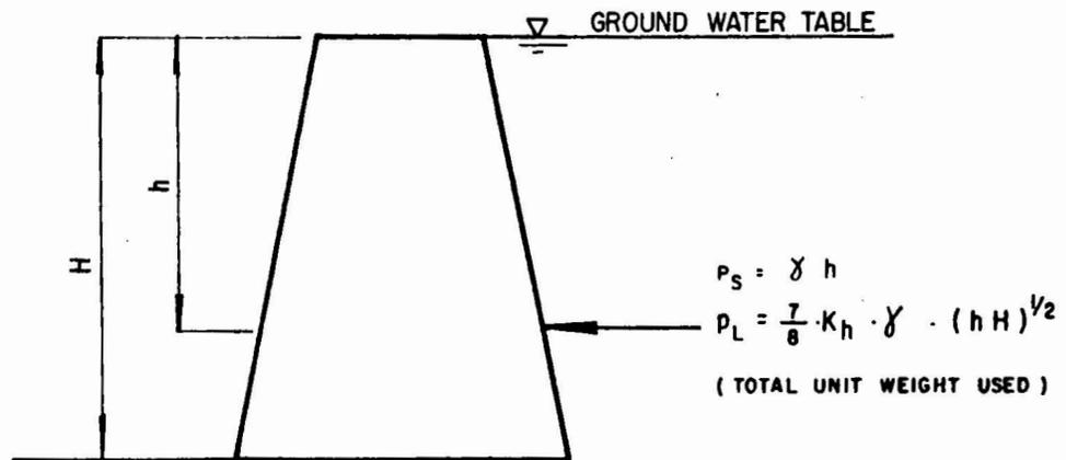
FIG. 12 DYNAMIC EARTH PRESSURE AT DEPTH  $h$  DUE TO A LIQUEFIED BACKFILL
